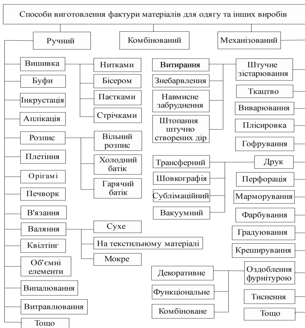
Рис. 2. Систематизація способів виробництва фактури матеріалів для одягу та інших виробів
