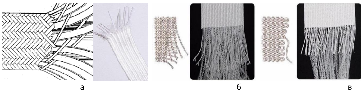
Рис. 10. Різновиди еластичної тасьми за способом виготовлення: а – плетена; б – ткани; в – в'язана [14]
